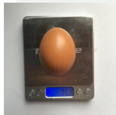
Gambar 4. 11 Hasil pengujian berat telur oleh timbangan digital
