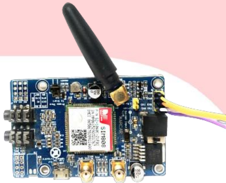
Gambar 2. 7 Bentuk fisik Modul SIM 808
