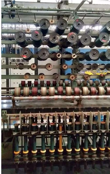
Gambar I. 2 Mesin yang Digunakan pada Proses *Twisting*
