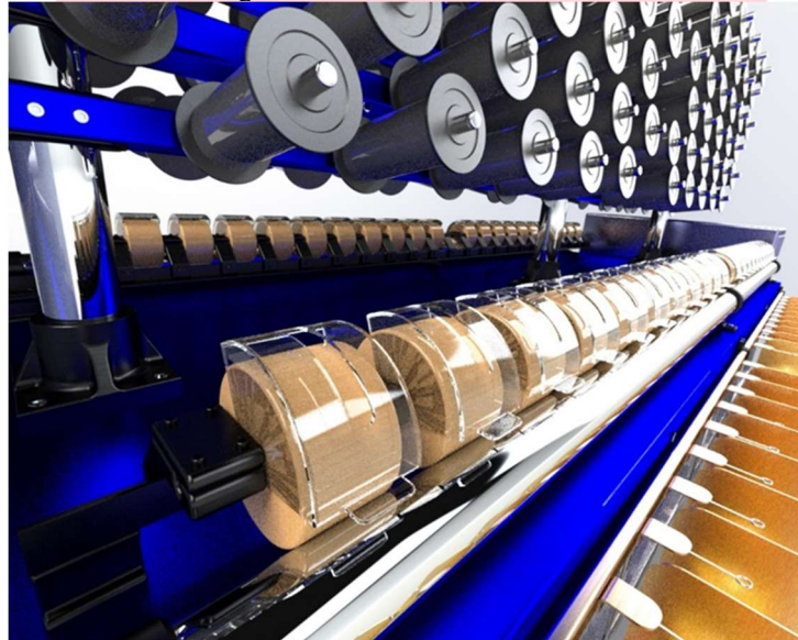
Gambar 3 Rancangan Usulan Penambahan Pembatas Antar Roda
