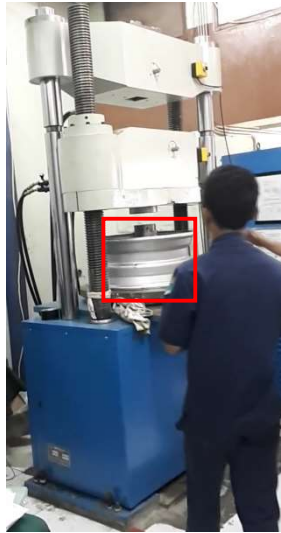
Gambar I.2 Hazard pada Mesin Uji Shearing
