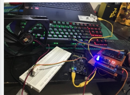
Gambar 4. 5 Sensor DHT22 Ketika Membaca Suhu Dingin
