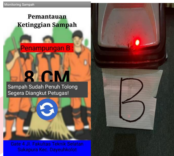
Gambar 4.15 Pemantauan Ketinggian Penampungan B 2 Gambar 4.15 merupakan foto atau tampilan ketika pemantauan ketinggian sampah mendeteksi penampungan sampah B penuh dari aplikasi android pemantauan tempat penampungan sampah
