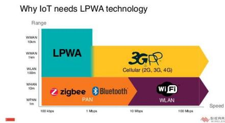
**Gambar 1.1** Perbandingan LPWA, Cellular, WLAN, dan PAN [7].
