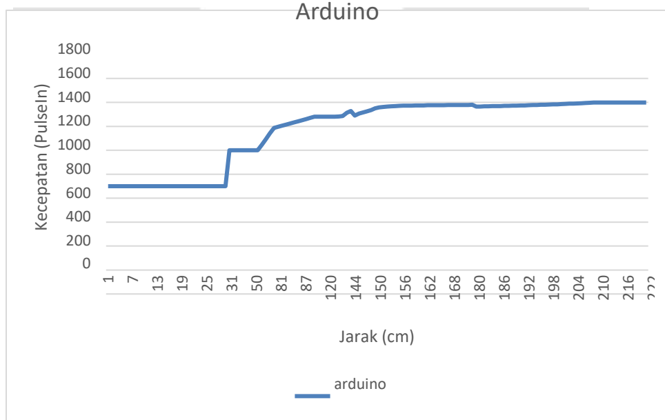
Gambar IV-3 Grafik Nilai Kecepatan Pada Arduino
