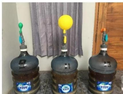
**Gambar 3. 1** Pengamatan Produksi Biogas
