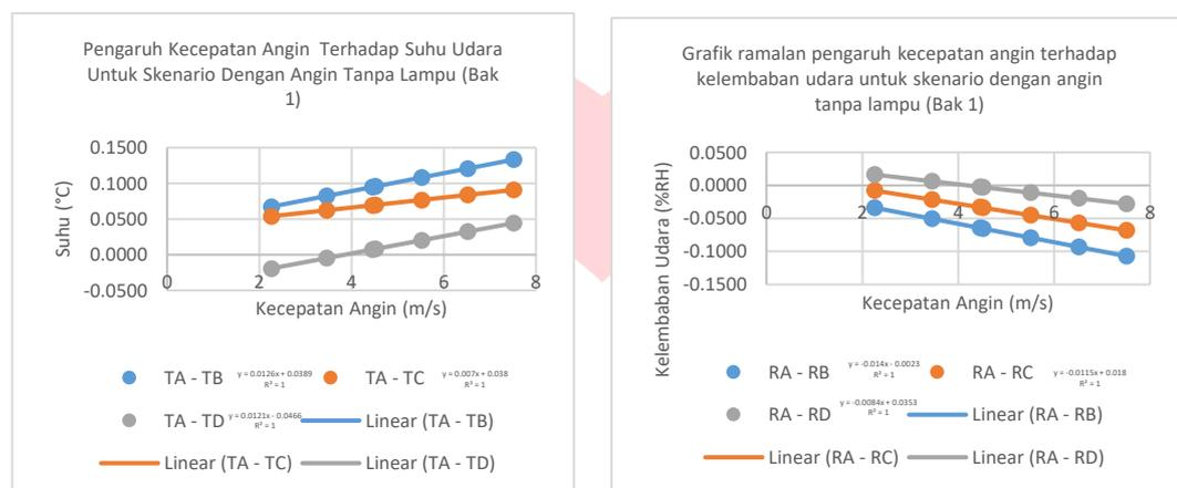
Gambar 6. Grafik Ramalan Pengaruh Kecepatan Angin Terhadap Suhu dan Kelembaban Udara Untuk Skenario Dengan Angin Tanpa Lampu (Bak 1)
