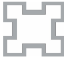
Gambar 2. 3 Bentuk Filter Meander Loop Resonator [4]
