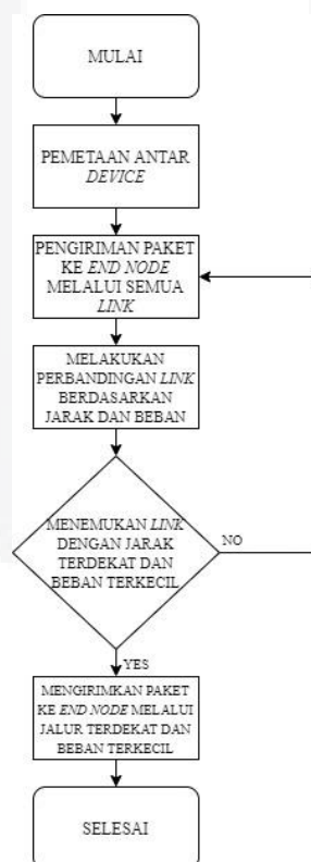
Gambar 3.1 Diagram blok algoritma optimasi koloni semut
