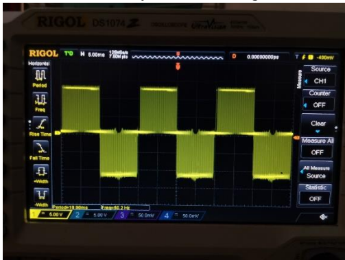
Gambar 4.2 Hasil Sinyal SPWM dengan Time/Div 5ms
