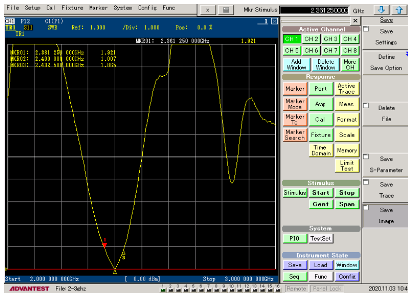
Gambar 4.3 Hasil Pengukuran VSWR substrat rubber
