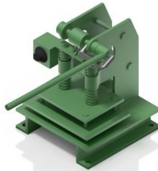
Gambar 6 Usulan Poka Yoke pada Mesin Emboss
