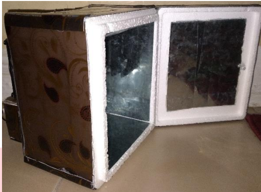
Gambar 2.2 Pembuatan Portable Mini Chiller
