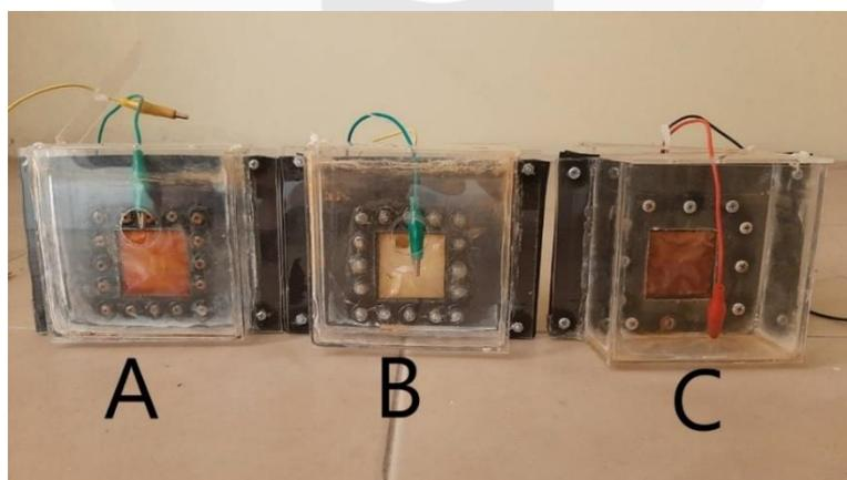
Gambar 3. 4 Reaktor *stacked* MFC setelah eksperimen.
