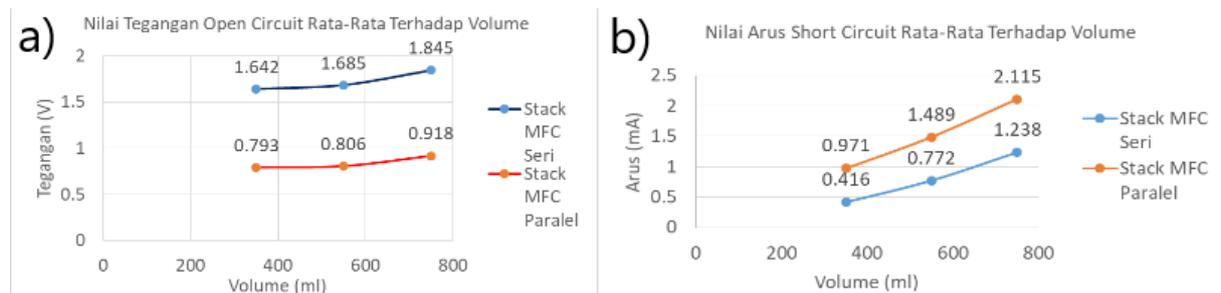
**Gambar 3.5** (a) Grafik tegangan *open circuit* rata-rata terhadap volume, dan (b) Grafik arus *short circuit* rata-rata terhadap volume.
