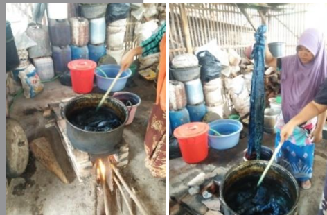
Gambar 16. Proses pelorodan Sumber: Dokumentasi pribadi, 2021
