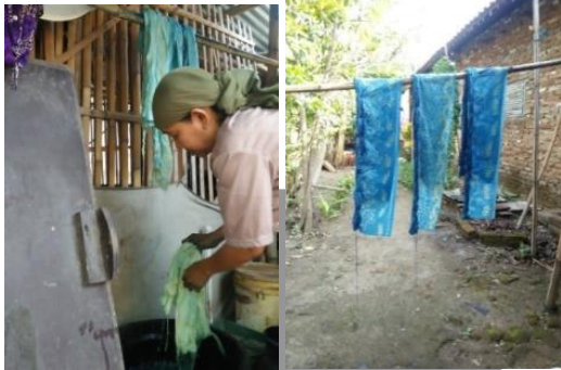
Gambar 12. Proses pencelupan kain dan pengeringan Sumber: Dokumentasi pribadi, 2021
