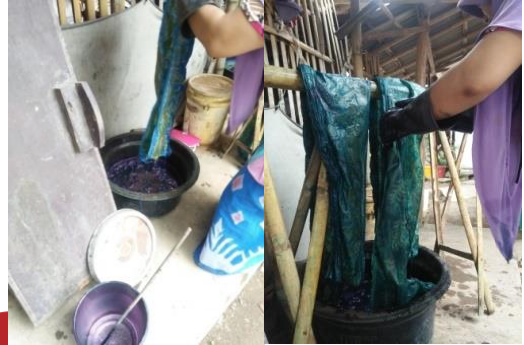
Gambar 14. Proses pencelupan kedua Sumber: Dokumentasi Pribadi, 2021
