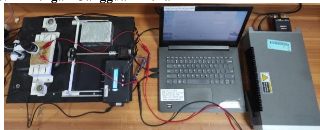
Gambar 2. 2 Skema pengukuran sifat listrik dengan gangguan mekanik
