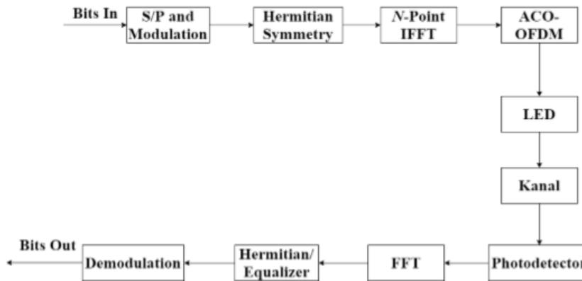
arus DC) untuk *transmitter* VLC. Pada ACO-OFDM *subcarrier* yang memiliki nilai indek genap maka dibiarkan nol. ACO-OFDM menghasilkan sinyal *non-negatif* yang cocok untuk sistem VLC dengan cara hanya memodulasikan *subcarrier* frekuensi bernomor ganjil. Berikut gambar blok diagram ACO-OFDM[9].
