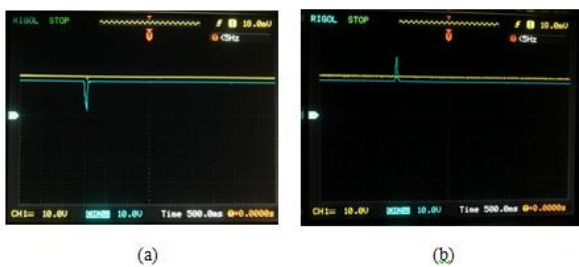
Gambar 4. 15 Hasil Pengukuran Beban di 65 \Omega Menjadi (a) 60 \Omega (b) 70 \Omega (Note : x = 500 ms/div dan y = 5V/div , Sinyal Kuning = Input , Sinyal Biru = Ouput)
