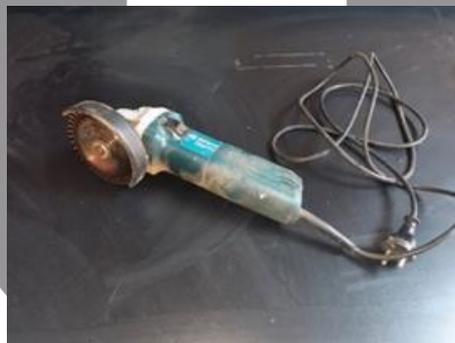
**Gambar 6.** Gerinda tangan untuk memotong
