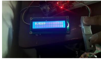
Gambar 4.(f) Pengukuran Massa dengan Load Cell
