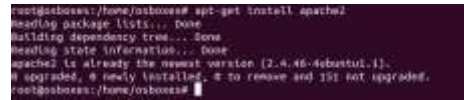
Gambar 4. 22 Install Paket Apache di ubuntu 2. Akses web apache dengan mengetikan IP Address dari Ubuntu.
