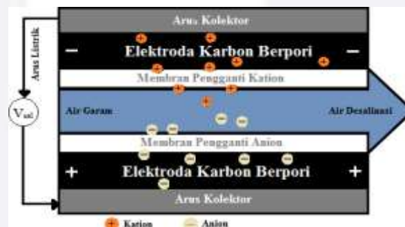
Gambar 2 Prinsip Kerja Membran Sel CDI
