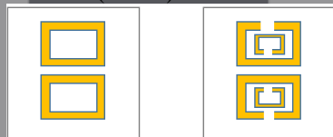
Gambar 1. Bentuk design dari metamaterial DRR (kiri) dan SRR (kanan) pada bagian groundplane
