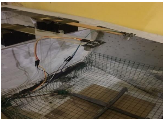
Gambar 10 Pemasangan Sensor Ping
