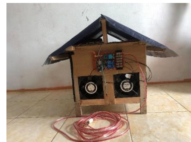
Gambar 7 Rancangan Sistem Kendali Suhu
