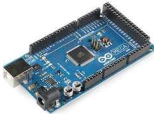
Gambar 2.6 mikrokontroler pabrikan Arduino[10]
