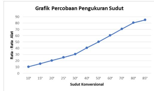
GAMBAR 4.2 Grafik Pengujian MPU6050
