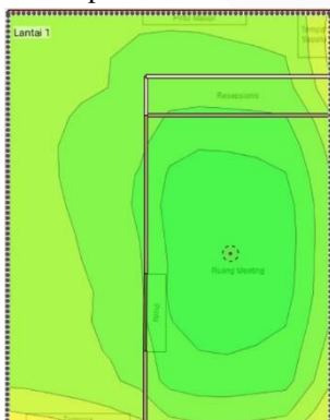
GAMBAR 5 Penempatan Access Point
