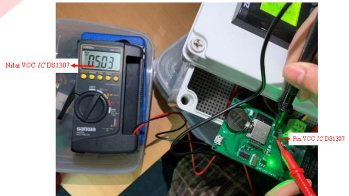
GAMBAR 11 UJI TEGANGAN PADA IC DS1307
