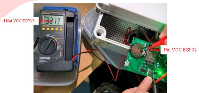
GAMBAR 7 UJI TEGANGAN PADA KOMPONEN ESP32
