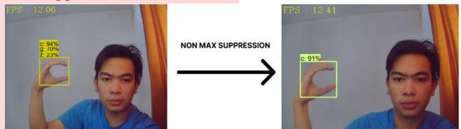
GAMBAR 4 ilustrasi non-max suppression
