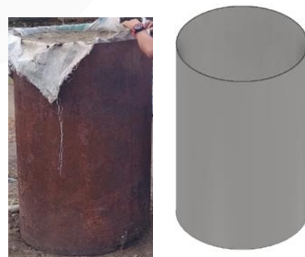
GAMBAR. 4 Gambaran nyata dan geometri pemodelan drum ponton
