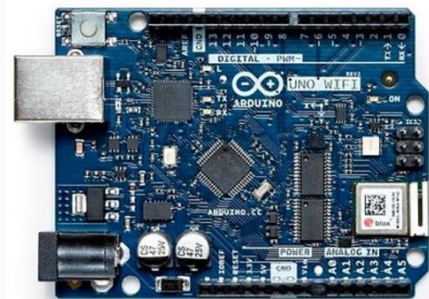
GAMBAR 3 MIKROKONTROLLER ARDUINO UNO
