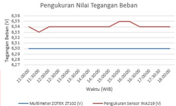
Gambar 4. 5 Pengujian pengukuran nilai tegangan beban dengan sensor INA219
