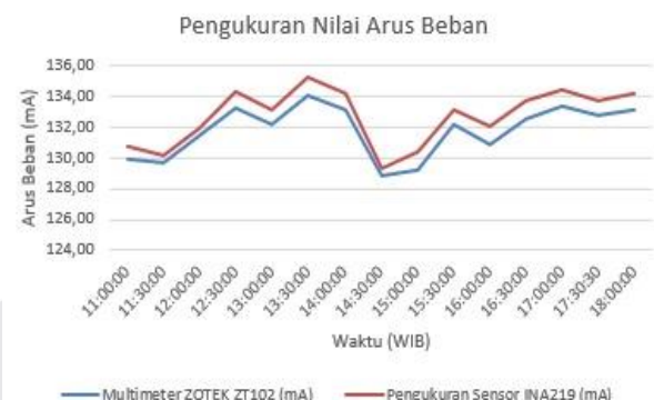
Gambar 4. 6 Pengujian pengukuran arus beban dengan sensor INA219
