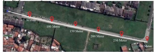
GAMBAR 13 PENGUJIAN JARAK MODUL LORA
