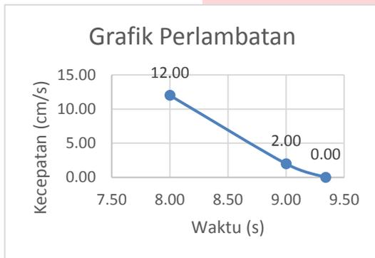
Gambar IV-5 Grafik Perlambatan Pengujian Kecepatan Aman
