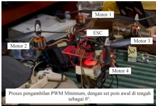
Gambar 7 Pengujian Motor untuk PWM Minimum
