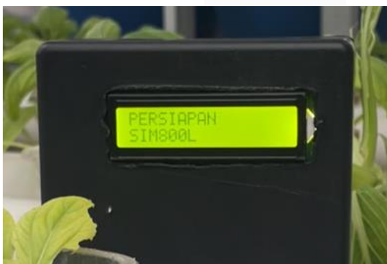
Gambar 4. 3 Tampilan Proses Persiapan Modul GSM SIM 800L
