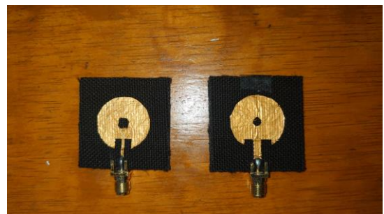
Gambar 4. 5 Tampak depan antena setelah di solder
