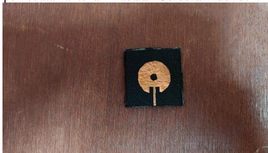
Gambar 4. 1 Tampak depan antena konvensional
