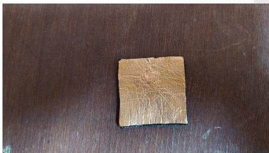
Gambar 4. 2 Tampak belakang antena konvensional
