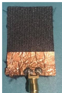
Gambar 4.2 Tampak belakang antenna fabrikasi.
