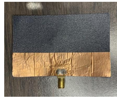
Gambar 9 Hasil Fabrikasi Antena Tampak Belakang
