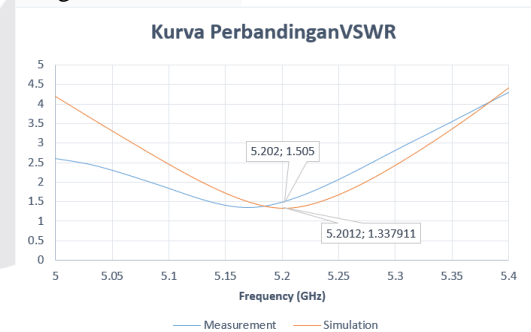
GAMBAR 7 PERBANDINGAN HASIL PENGUKURAN DAN SIMULASI VSWR
