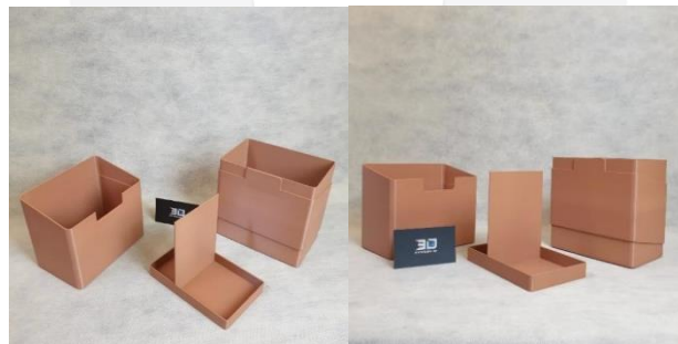
Gambar 20 Gambar prototype hasil cetak 3d
