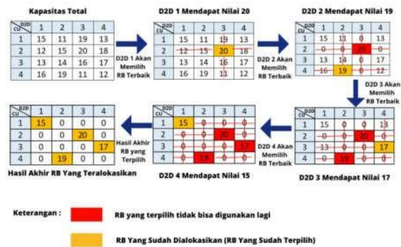
GAMBAR 3 ILUSTRASI CARA KERJA ALGORITMA GREEDY
