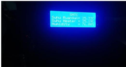
Gambar 4.3 Hasil Pengujian Sensor Kelembapan
