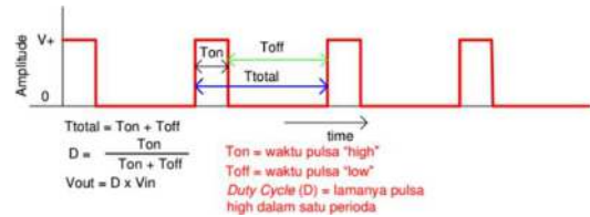
Gambar 2.6 Sinyal Amplitudo PWM
