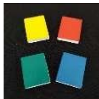
Gambar 12 pion board game dengan material 3D print resin SLA
