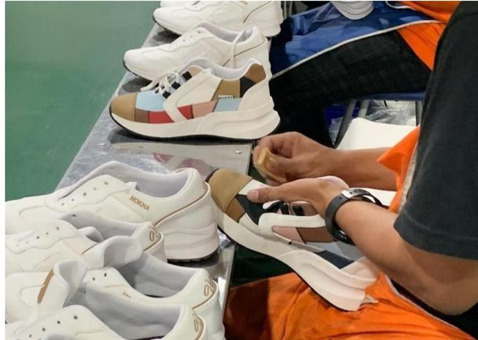
Gambar 12: Proses terakhir memasang tali sepatu
