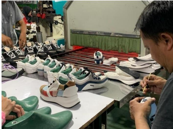
Gambar 10: Proses pengeleman sol dan upper proses pemanasan
