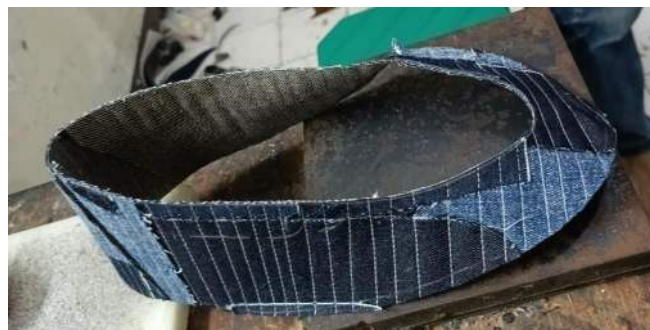
Gambar 4. 9 Proses pemotongan dan penggabungan pola (Sumber: Dokumentasi Penulis)
